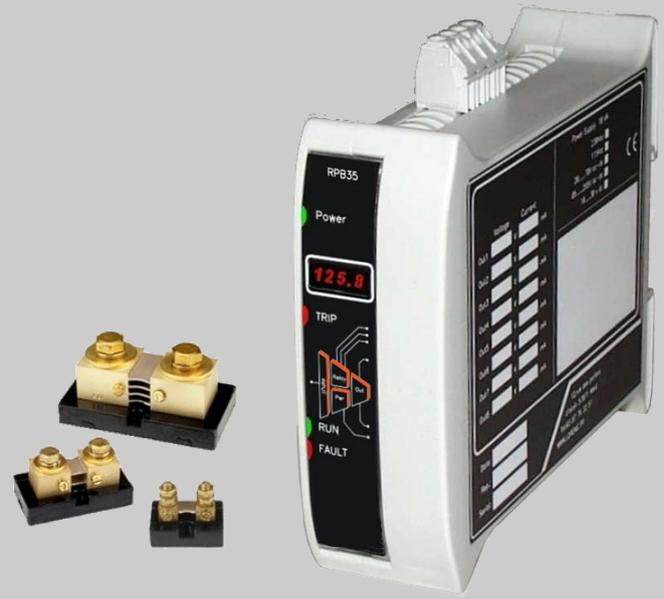
Le RPB45S est un relais de protection de batteries universel, associé à un shunt, il permet de mesurer n'importe quelle intensité. Les seuils et temporisations de protection sont librement ajustables pour chaque direction de courant (charge et décharge), permettant de couvrir tous les types de batteries. Le RPB45S est doté d'une sortie analogique isolée permettant la recopie de la mesure du courant.
